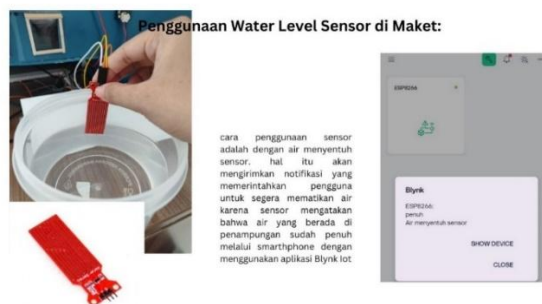
Gambar 8. Penggunaan Sensor Water Level
