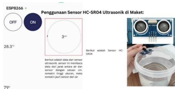
Gambar 7. Penggunaan Sensor Ultrasonik
