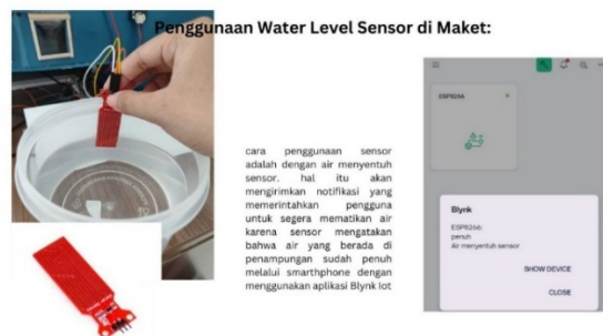
Gambar 9. Penggunaan Sensor Water Level
