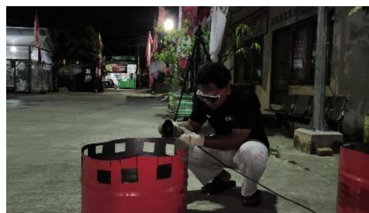
Gambar 2. Proses fabrikasi dan pemeriksaan fisik unit insinerator sederhana
