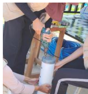
Gambar 5. Pengeboran Lubang Pipa Biopori
