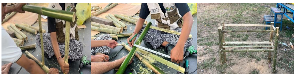
Gambar 5. Pembuatan kerangka bambu sebagai penyangga tiga wadah tong sampah.
