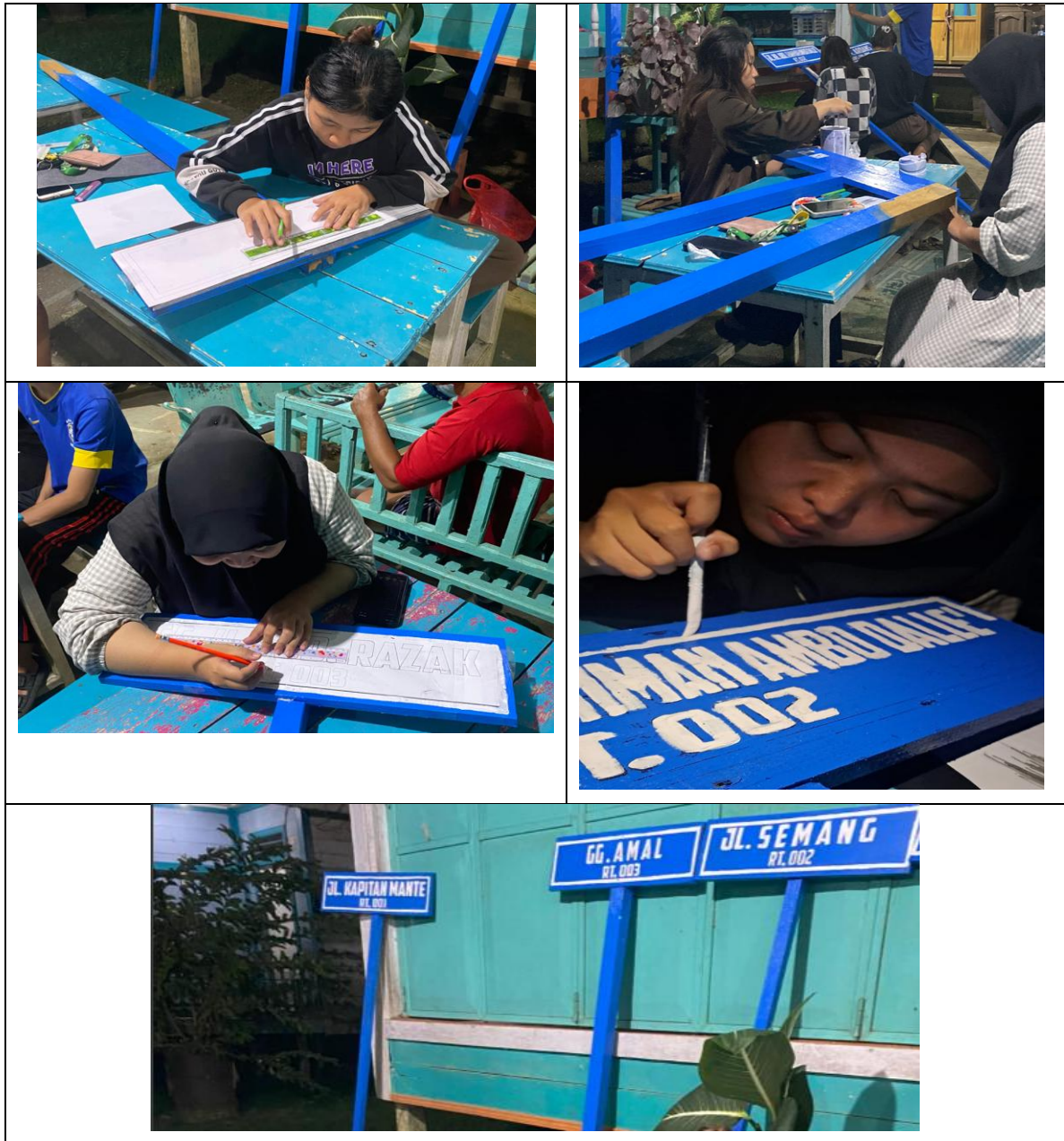
Gambar 3. Proses Finishing Pajalis dengan Pembuatan Pola Tulisan dengan Menggunakan Kertas Karbon
