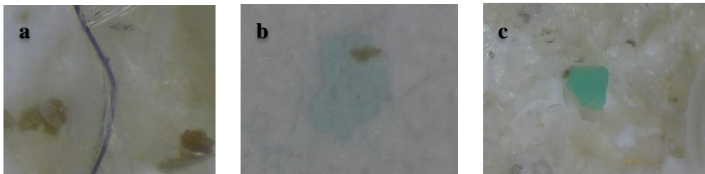
Gambar 1. Hasil identifikasi jenis mikroplastik pada saluran pencernaan ikan kembung di TPI Selili ; (a) fiber, (b) film (c) fragmen
