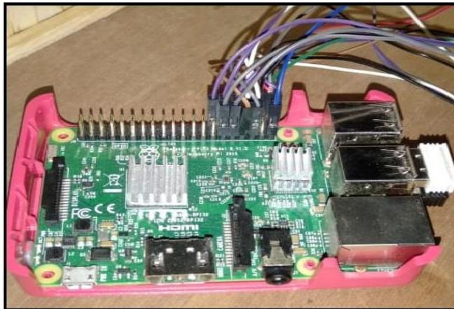
Gambar 4. Pemasangan Kabel ke GPIO
