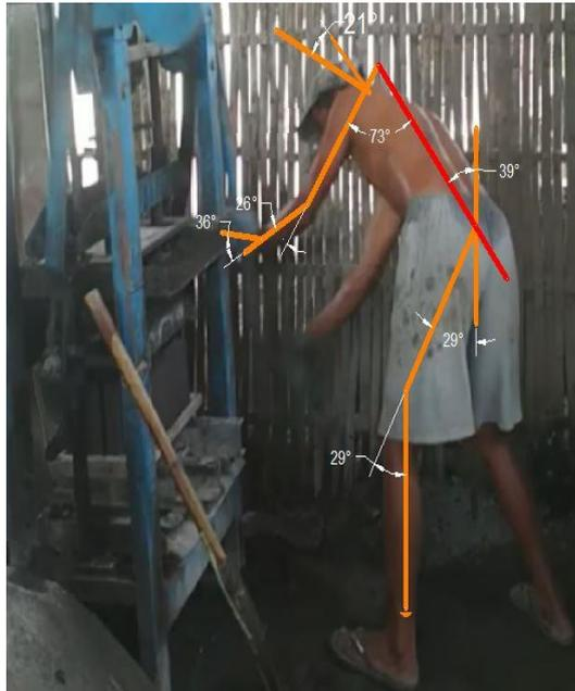
**Gambar 3.** Mengepress Adonan Batako
