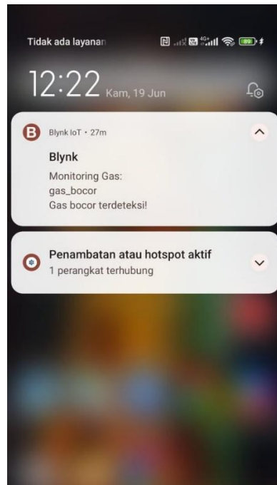
Gambar 9. Notifikasi apabila terjadi kebocoran gas
