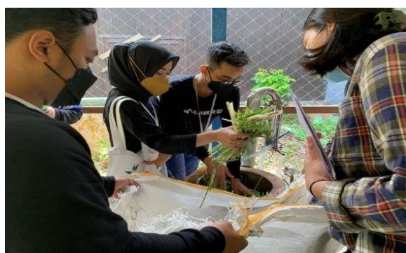
Gambar 6. Proses Memasukkan Bahan Baku Kedalam Ketel Suling
