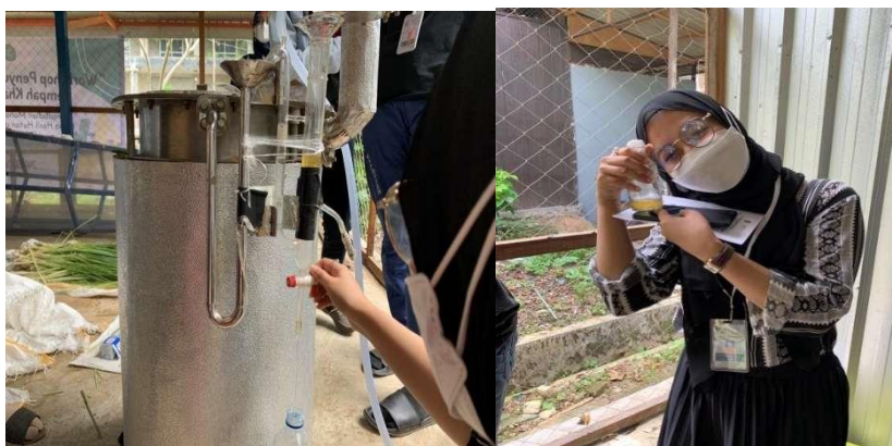
Gambar 8. Proses Pemisahan Minyak Atsiri dan Air
