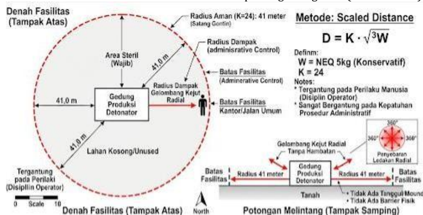
Gambar 1. Skema Desain Konvensional Tanpa Penghalang Fisik ( Unbarricaded )
