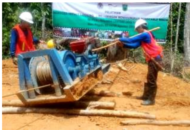
Gambar 8. Praktek penyaradan log pada saat menarik beban yang berat.
