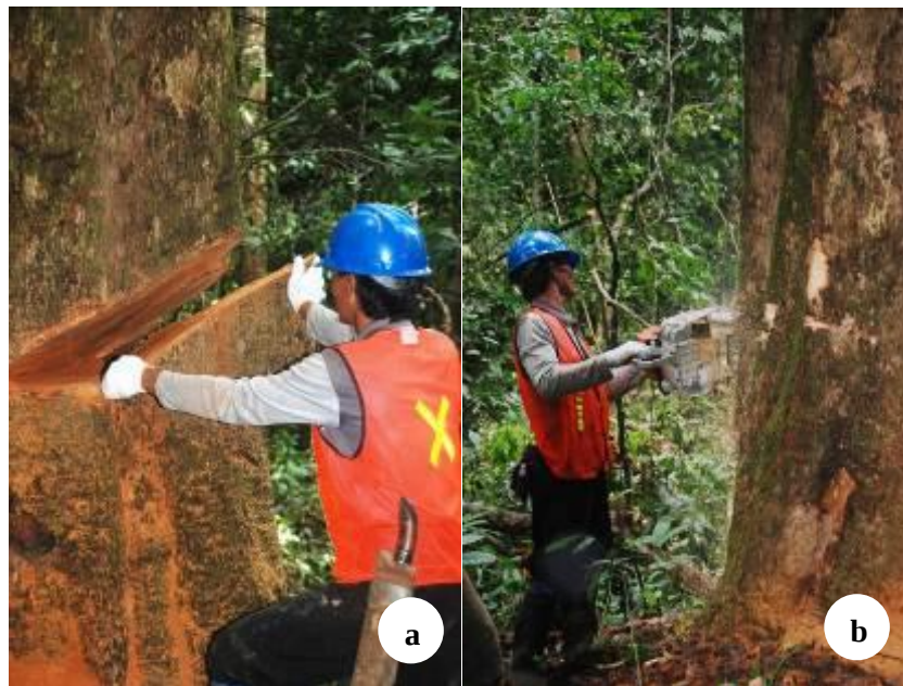
Gambar 5. Praktek pembuatan takik rebah dan takik balas (Aipassa, 2023).
